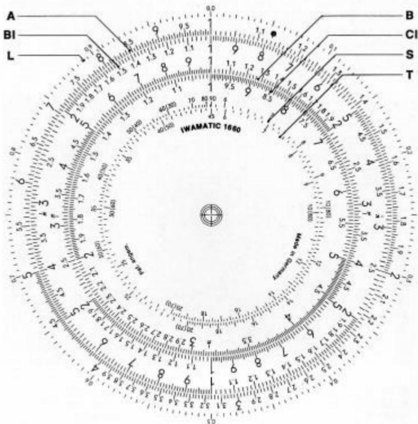
Die IWAMATIC besitzt 4 Hauptskalen für die Multiplikation und Division. Der Einfachheit halber werden sie mit den Buchstaben **A**, **BI**, **B** und **CI** bezeichnet. Der Zusatz **I** bedeutet invers, d. h. diese Skalen laufen gegen den Uhrzeigersinn.
